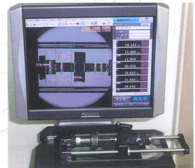
自動形状測定機 (ボルト測定例)
