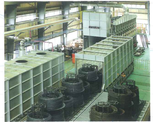
無酸化球状化焼鈍炉
